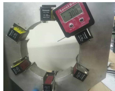
图 9 周向角度误差修正 Fig.9 Correction of circumferential angle error
